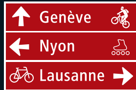
4.50.6 Indicateur de direction en forme de tableau destiné à plusieurs cercles d'usagers
