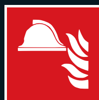
F004 Equipements de lutte contre l'incendie
