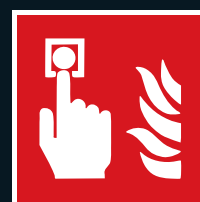
F005 Alarme d'incendie
