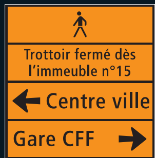
Indicateur de direction de déviation pour piétons
