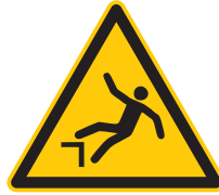
W008 Warnung vor Absturzgefahr
